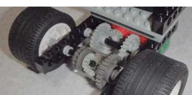
前輪かじ取り用の「サーボモータ」はネットで購入しました。後輪に動力を送るギアの部分はLEGOの部品を探して作りました。(左図)
